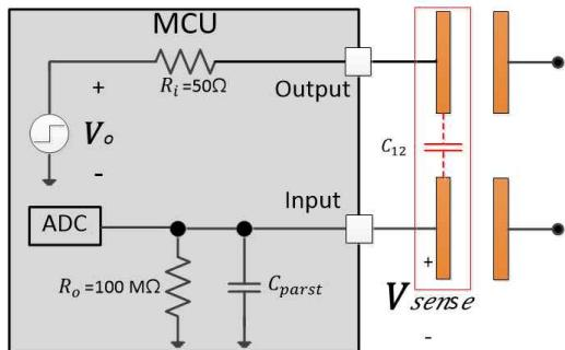
그림 3 커패시터의 측정 원리
