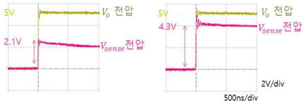
그림 5 분리 시( $C_{12}=18\text{pF}$ )와 완전정렬 시( $C_{12}=157\text{pF}$ )  $V_{sense}$  전압
